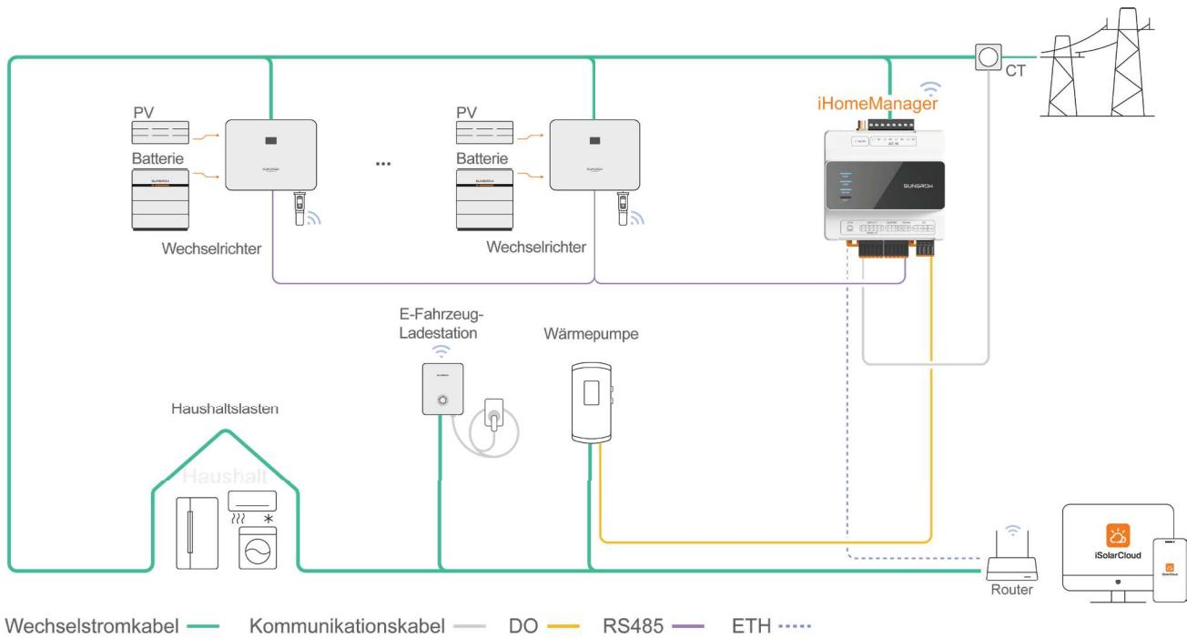
\* iHomeManager unterstützt sowohl die kabelgebundene als auch die kabellose Kommunikation mit dem Wechselrichter. In der obigen Abbildung ist die kabelgebundene Lösung zu sehen.
